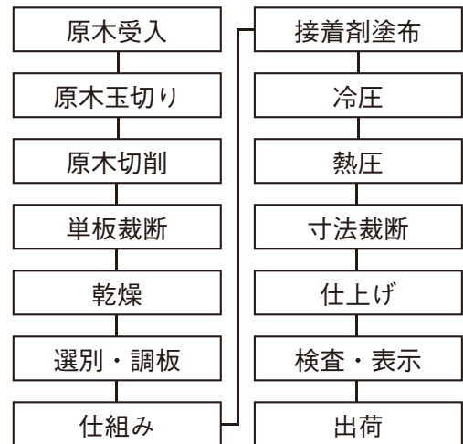
図1 合板の製造工程
